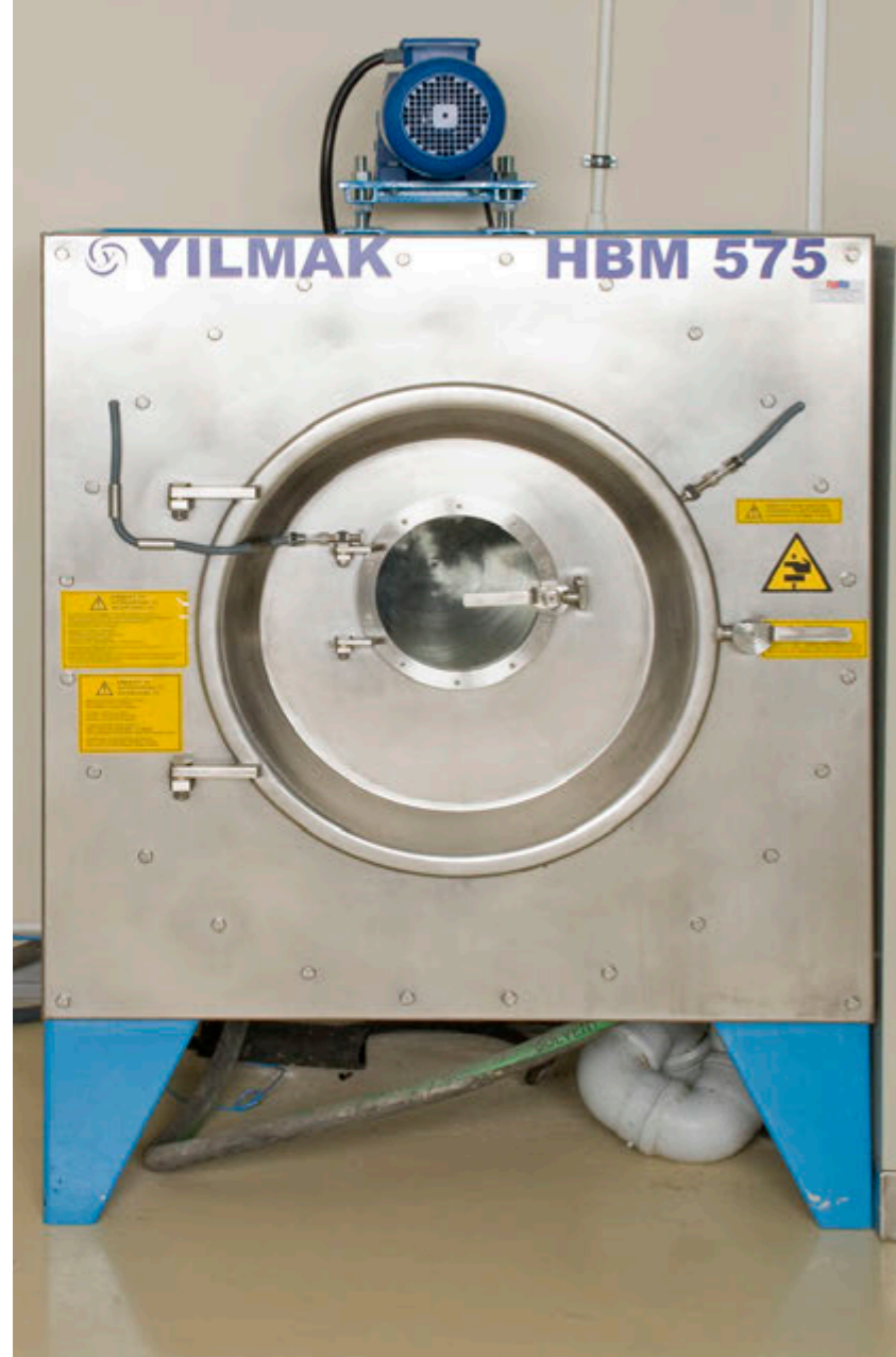
Sanayii tipi yıkama makinesi Yıkama işlemlerinde ve denim kumlamada kullanılır.
