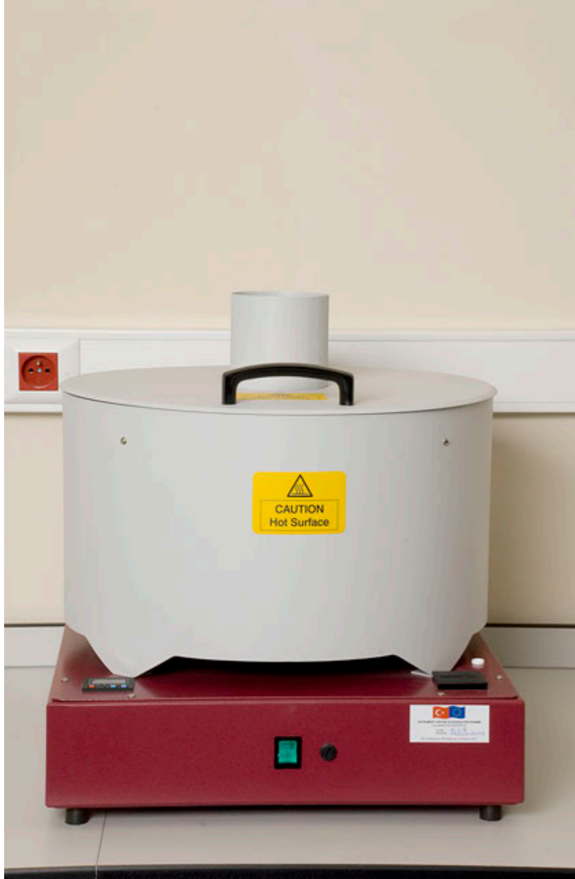
ATLAS Işık Haslık Test Cihazı Tekstil ürünlerinin kuru ortamda ışık ve UV haslık testlerinin tespitinde kullanılmaktadır.
