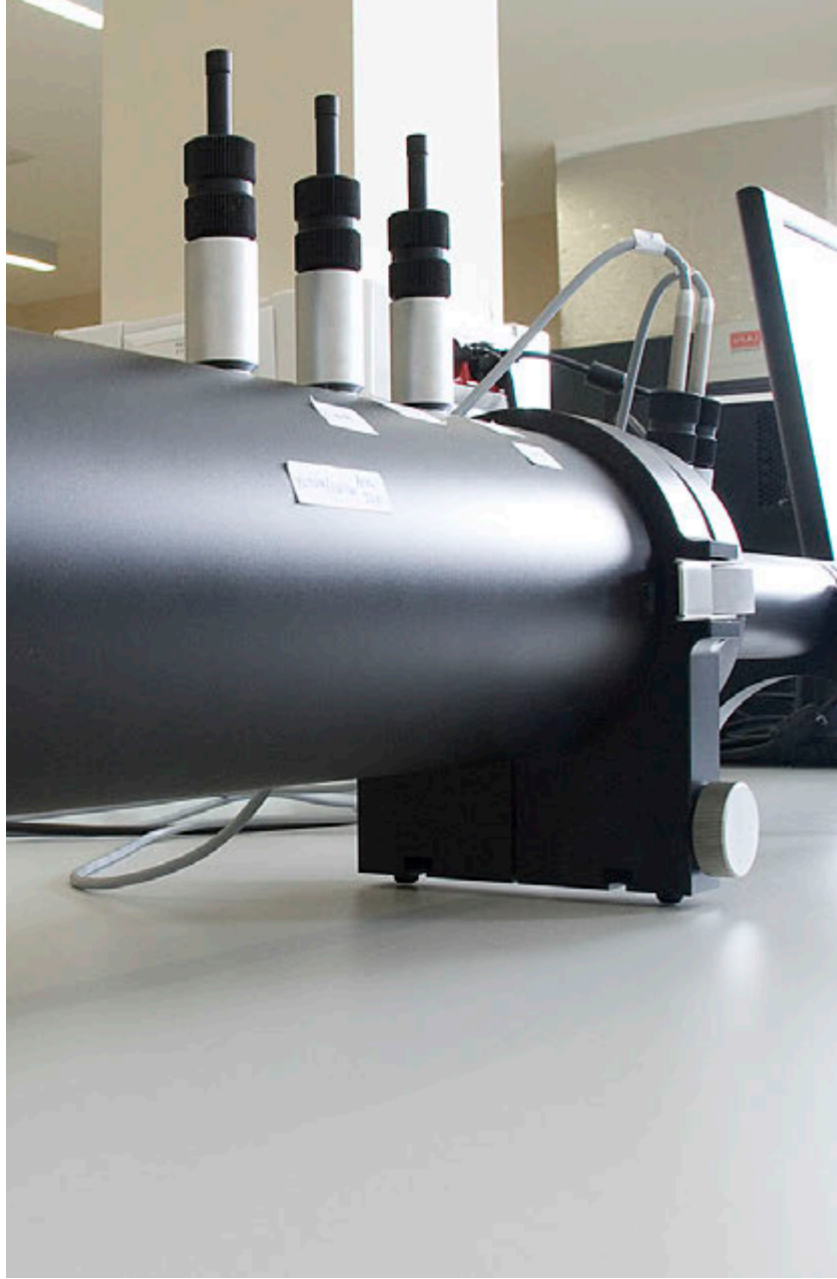
Ses Geçirgenlik Katsayısı Ölçüm Cihazı Tekstil materyallerinin ses yutum katsayısını ve ses iletim kaybını frekansa bağlı olarak ölçer. 50-6400 Hz frekans aralığında ölçüm yapar.
