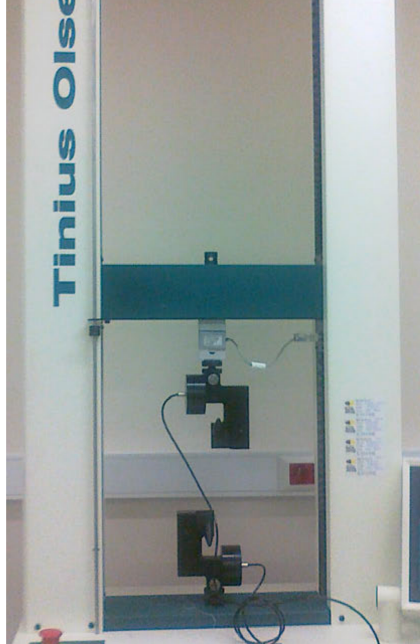
Mukavemet Test Cihazı (Lif, İplik ve Kumaşlar için)
